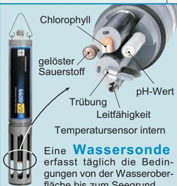
Eine **Wassersonde** erfasst täglich die Bedingungen von der Wasseroberfläche bis zum Seegrund.
