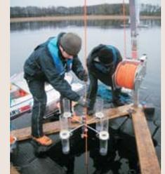
**4-Zylinder-Fallen** sammeln die Planktonproduktion der Sedimenteintrag in 5 und 12 m Wassertiefe.
