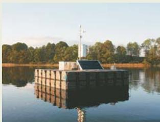
Eine **Wetterstation** erfasst die meteorologischen Bedingungen auf dem See (Temperatur, Luftfeuchte, Niederschlagsmenge, Windgeschwindigkeit, Windrichtung, Luftdruck und Globalstrahlung).
